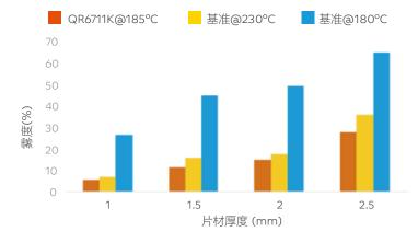
图表显示一般上使用于高透明度薄壁包装的SABIC®PP QR6711K 在较低的加工温度下也能体现高透明度。和基准比较起来,SABIC®PP QR6711K 的高流动性和高结晶温度使它能够减少10%注塑周期时间。结合这些优势的情况下,相较于基准,SABIC®PP QR6711K 可能能较少10%的耗电量。
