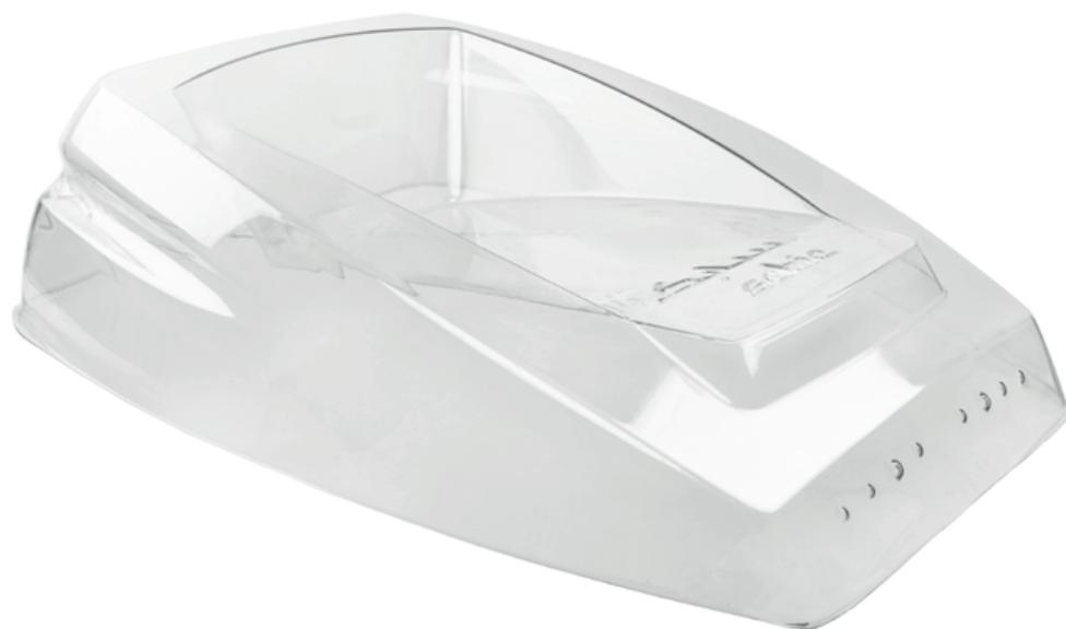
LEXAN EXTRITE 板材属于聚碳酸酯材料，其热成型是一种制造工艺，塑料板材首先被加热至软化温度，通过使用真空在模具内部或上方形成特定形状，然后经过修整生成可用的产品。
